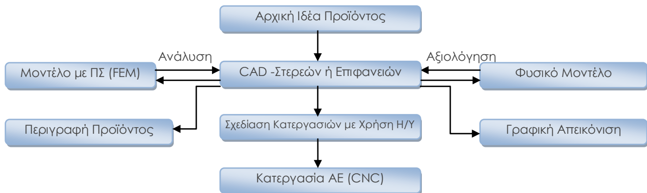
Εικόνα 6: Μέθοδος κατεργασίας με χρήση συμβατικών μεθόδων και μεθόδων CAD.
